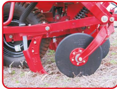
**Disco de corte:** Com lamina de 16" de linha e 17" opcional eficiente poder de corte e sistema com oscilação lateral para acompanhar curvar nos terrenos. Opção de montagem com sulcador facão ou disco duplo desencontrado.
