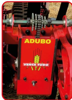
**Regulagem Fertilizante:** Através do sistema de troca rápida e com opção 100 velocidades diferentes, para uma distribuição contínua e precisa.
