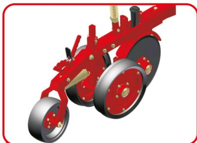
**Mecanismo de cobertura:** O conjunto de duas rodas em "V" limitadoras de profundidade para semente. Com 3ª roda compactadora do sulco de plantio.
