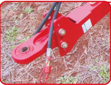
**Cabeçalho:** Articulável, permitindo posição de operação ou armazenamento. Com regulagem de altura da ponteira para nivelamento da máquina através de um regulador.(3º ponto)
