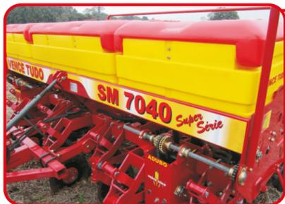
**Reservatório de Fertilizantes:** Modulado construído em polietileno, com estrutura anticorrosiva. Com o eficiente sistema de esgoto, possibilitando maior agilidade para limpeza do reservatório.
