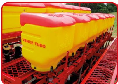
**Reservatório de Sementes:** (grãos grossos) Tipo balde, em polietileno com capacidade de 36Kg/45L por linha.
