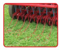
Sistema de fechamento e cobertura do sulco de plantio: Através de argolas fixadas em cada linha de semeadura.
