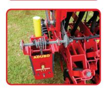
Regulagem de dosagem para fertilizante: De fácil acesso, é através de troca de engrenagens dentadas.
