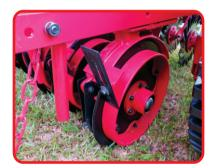
Sistema de ataque ao solo para colocação da semente: Através de disco duplo de 13x14' proporcionando uma colocação uniforme e precisa da semente ao solo.
