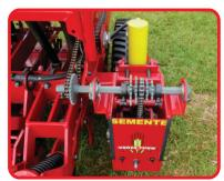
Regulagem de dosagem para semente: De fácil acesso, é através de mecanismo de abertura de talas alimentadoras dos rotores.
