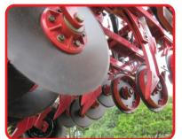
Sistema de ataque ao solo: Através de disco de corte de 16´´.
