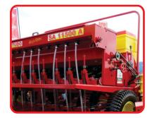
Regulagem de dosagem semente 3º caixa: De fácil acesso, é através de mecanismo de abertura de talas alimentadoras dos rotores.
