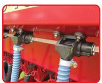
Distribuição semente em 3º caixa para micro sementes: Opção de 3º caixa para semente, com distribuição através de rotores. Possibilitando uma excelente distribuição através do método de semeadura consorciada.
