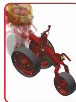
**Limitador em "V" independente com 3ª roda compactadora:** Limitador e compactador, com várias opções de regulagem, adaptando-se a qualquer tipo de solo. Todas as regulagens, de pressão, profundidade e compactação, sem necessidade de ferramentas.
