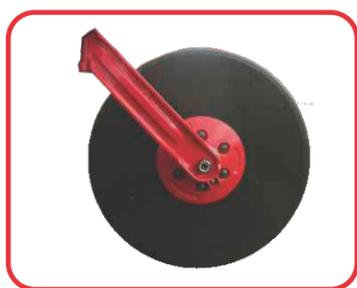
**Disco de Corte:** Sistema de disco de corte liso ou turbo (ondulado) de 20", independente da linha da semente, com giro livre e regulagem de altura.
